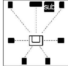
Wie auf Seite 2 unter „Positionierung des Subwoofers“ beschrieben, hast du verschiedene Möglichkeiten. Die obigen Abbildungen zeigen die optimalen Positionen der beiden Lautsprecher und des Subwoofers.
